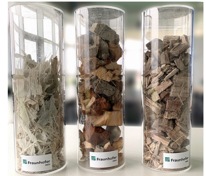
Geschredderte und voneinander getrennte Fraktionen aus einem Rotorblatt: GFK, PVC-Schaum, Balsaholz (von links nach rechts).
