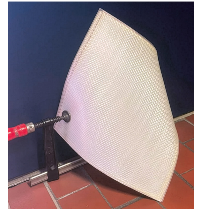
Abb. 2: Demonstration der elastischen Verformbarkeit eines flexiblen Organoblechs
